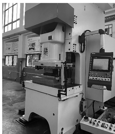
图 8 波纹板的成形设备
