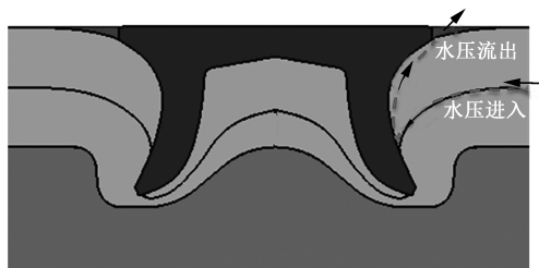
图 1 自冲铆接示意图
