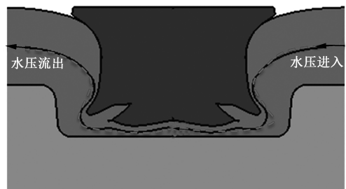
图 2 防水铆钉铆接示意图
