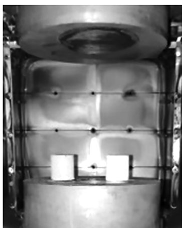
图 1 真空等温锻压机腔体中涂有两种玻璃润滑剂的试样
