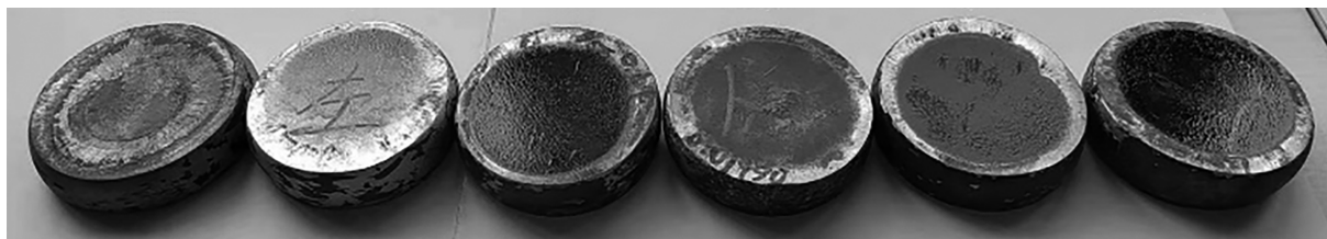
图 9 950 °C 时不同工艺条件下压缩后圆柱试样表面情况
