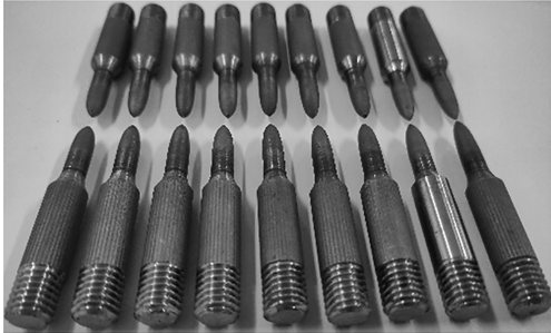
图 2 拉断后的试件
