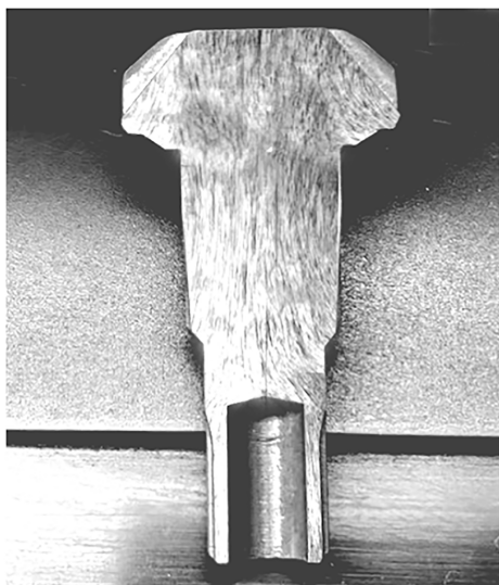
图9 花键轴断面流线
