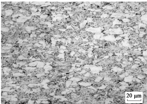
图 1 Gr. 38 钛合金板材的原始显微组织 Fig. 1 Original microstructure of Gr. 38 titanium alloy plate
