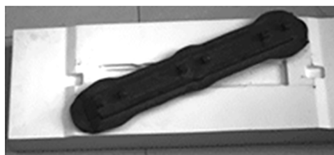
图8 常温下具有不对称飞边的刮板锻件
