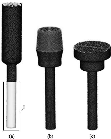
图 6 各工位零件成形结果
