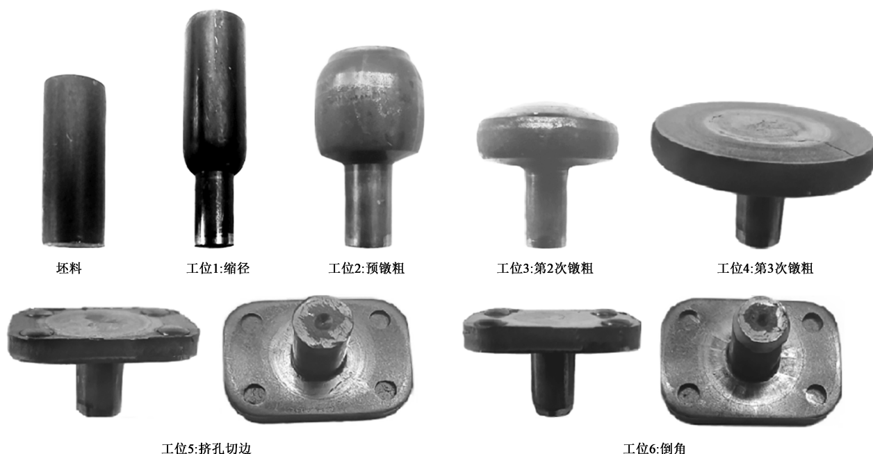
图9 凸焊螺栓各工位成形件
