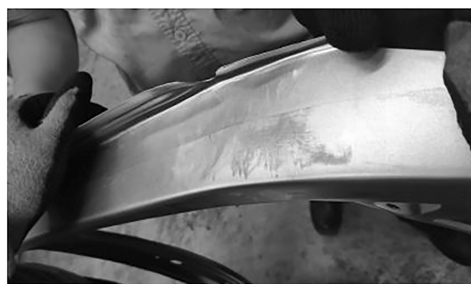
图9 后背门内板冲击线缺陷
