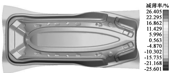
图 9 优化后零件材料厚度减薄率分布云图
