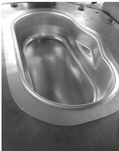
图 17 合格的初始工序件
