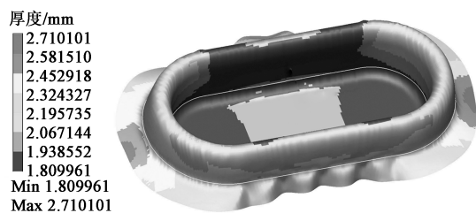
图 13 第 2 道次反拉深材料厚度变化云图
