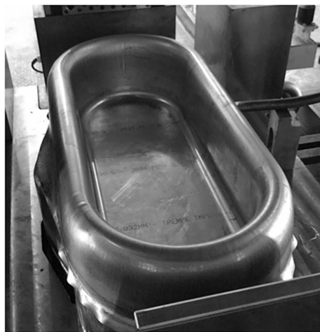
图 18 合格的最终成形工序件
