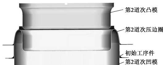
图 12 第 2 道次反拉深模拟模型
