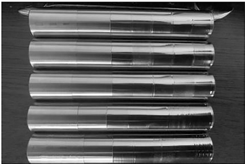
图 3 加工完成后的 304 不锈钢棒料 Fig. 3 304 stainless steel bars after processing
