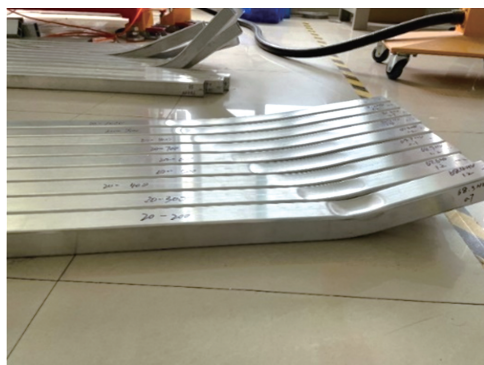
图 3 铝合金方管的弯曲件实物图
