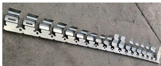
图 5 试冲后的条料
