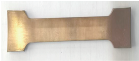
图 4 QSn7-0.2 锡青铜拉伸试片 Fig. 4 QSn7-0.2 tin bronze tensile test piece
