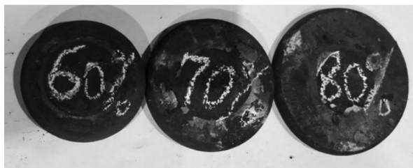
图 8 不同变形量下试样镦粗后的宏观照片
