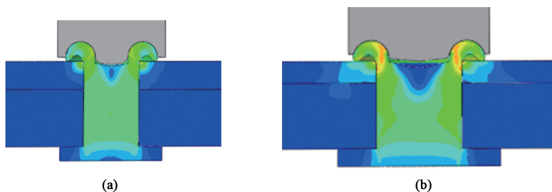
图 9 不同规格半空心铆钉压铆结果
