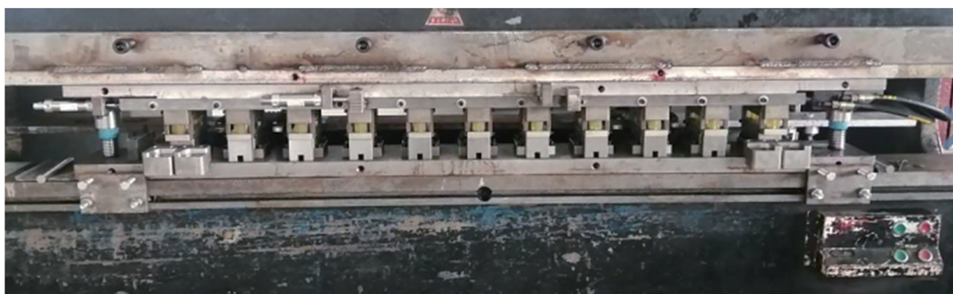
图 6 适配电液伺服折弯机后的组合冲孔模整体结构
