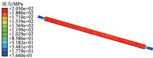
图 9 轧制完成后的应力云图 Fig. 9 Stress nephogram after rolling
