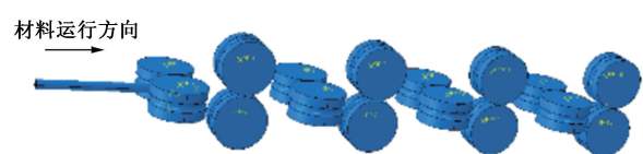
图 5 8 机架连续轧制模型 Fig. 5 Eight-stand continuous rolling model
