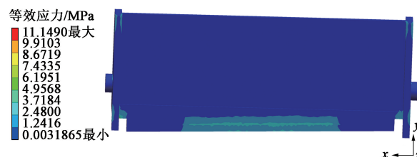
图10 裁剪到中间位置时的等效应力云图
