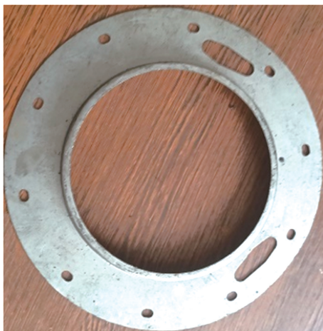
图 6 修边+冲孔的工序件
