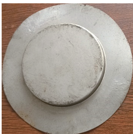
图3 落料+拉深①工序件
