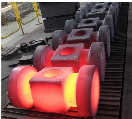
图 9 批量生产时阀体锻件两侧法兰成形情况
