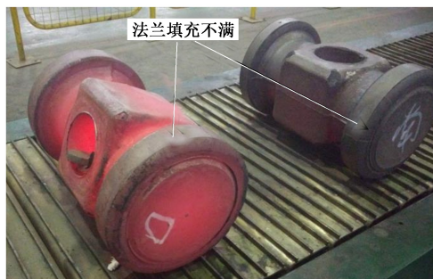
图 2 阀体锻件两侧法兰填充不满
