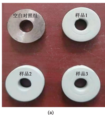
图6 圆环镦粗前后的样品
