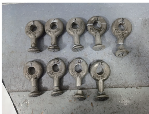
图 12 部分拉伸试验后的球头挂环样品
