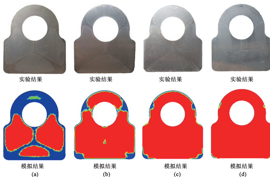
图 13 不同横截面处横向焊缝分布
